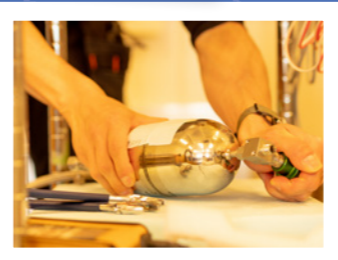
1週間に1回、ニーオルスンの空気を金属のフラスコに詰めます。この試料は日本へ発送し、空気中含まれる温室効果ガス等が分析されます。
